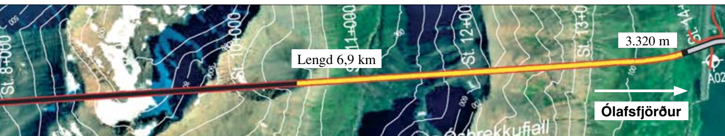
Búið er að sprengja 434 m í Héðinsfirði og 3.320 m í Ólafsfirði. Samtals 7.394 m sem er 70% af heildarlengd.
